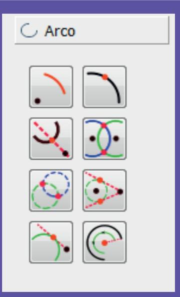
③ **Arc with given length** (Arco con una longitud determinada). Es parecido a la herramienta arco salvo en que ésta si que puedes dar una longitud concreta.
